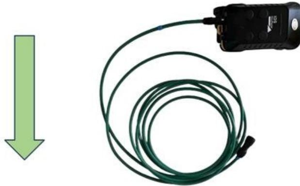
**PASO 2** – Enchufe el extremo opuesto del cable de conexión del C-thrue XS al conector del lado derecho del panel de enchufes del C-thrue
