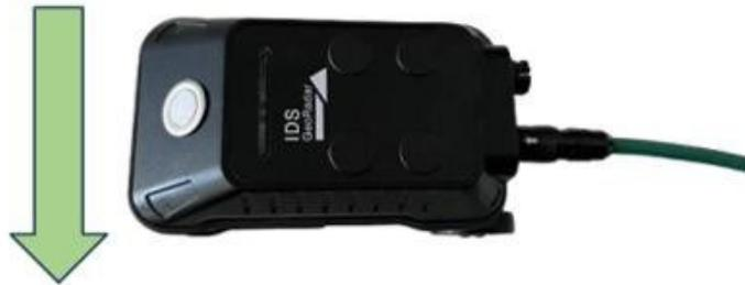
**PASO 3** – Conecte el enchufe LAN y el enchufe USB del divisor C-thrue XS, en el conector LAN y USB de la Tablet donde está instalado el software C-thrue Remote Desktop
