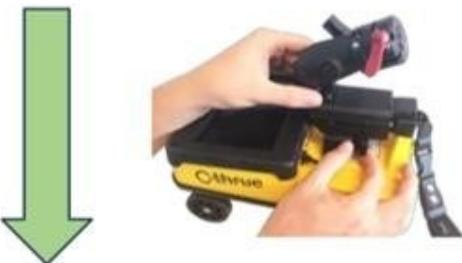
**PASO 3** – Insertar la pértiga en la cabeza pivotante del gancho
