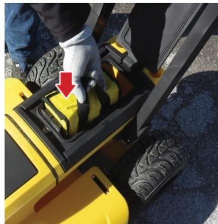
Inserte la batería con los conectores de la batería mirando hacia el frente del DS-2000.
