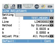
To reset the default parameters for **Method**, **a**, **b**, and **Adjust Pts**, press **Default**.
